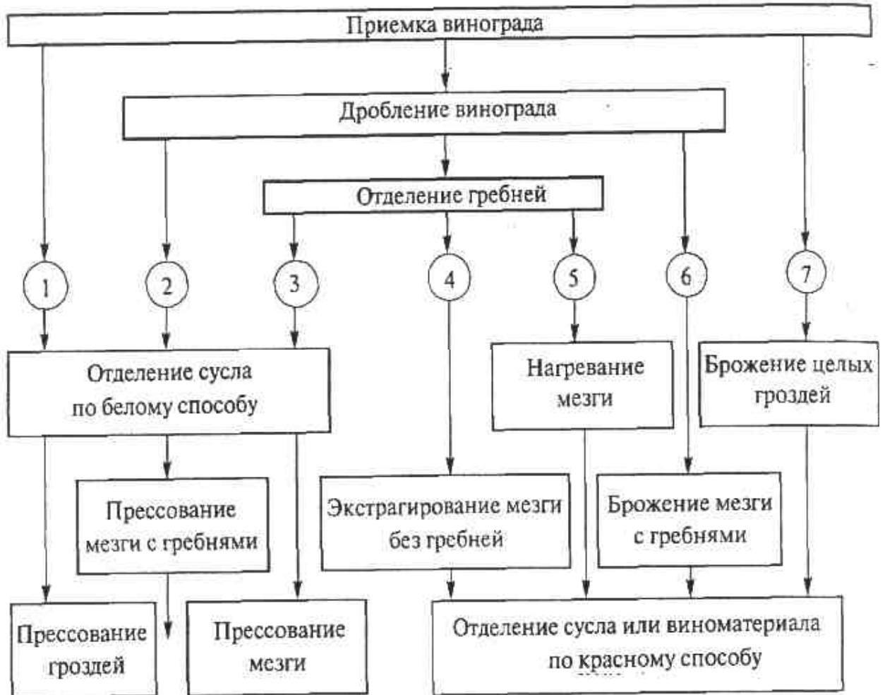
Рисунок 2. Технологические схемы переработки винограда по белому (1, 2 и 3) и красному (4, 5, 6 и 7) способам
